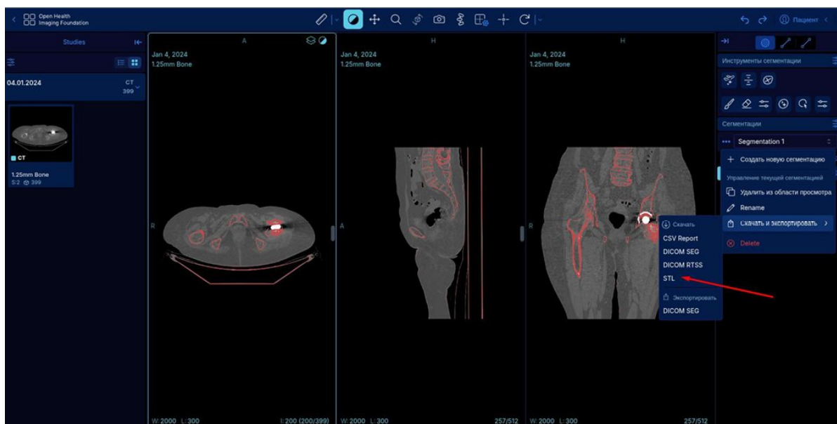
Рисунок 27 – Программный интерфейс экспорта подготовленной модели в универсальный формат STL
